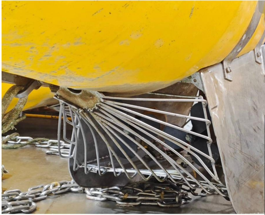
Figura 7-2: Boya de arranque de cables.
